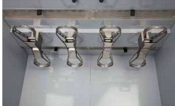
Beste Trocknungsergebnisse mit vier stabilen Aufhängern, zur effizienten Leitung des Luftstroms durch die Anzüge. Bei diesen Spezialaufhängern wird zuerst Heißluft durch die Innenseiten der Anzüge geblasen und dann außen um die Anzüge herum. In der Decke des Trockenschanks sitzen vier Flusenfilter.
